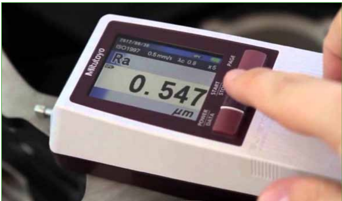
Figura 2. Rugosímetro MITUTOYO modelo SJ 210.
